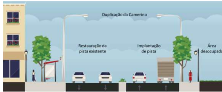
Figura 16: Seção esquemática do Sistema Camerino duplicado
