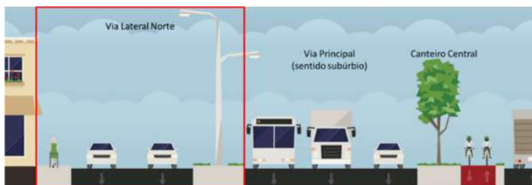
Figura 10: Seção esquemática da Via Lateral Norte
