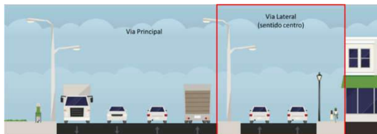
Figura 12: Seção esquemática da via lateral na Av. Menino Marcelo
